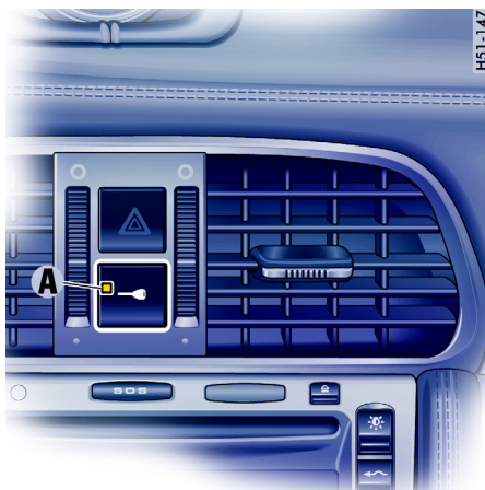
A - Светодиод охранной сигнализации
